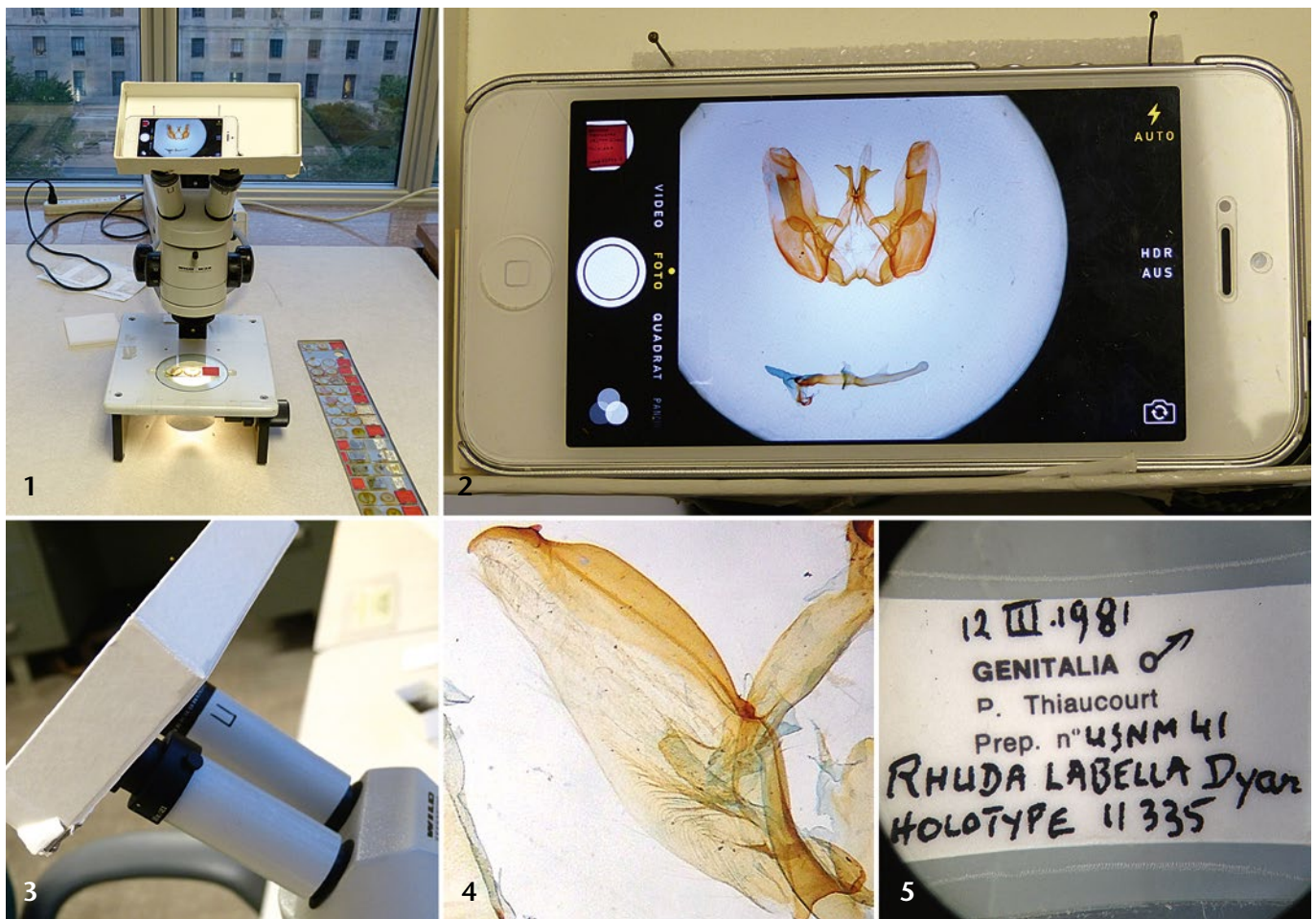
Abb. 1: iPhone-Halterung für ein binokulares Mikroskop. Abb. 2: Auf dem Display des iPhones wiedergegebenes mikroskopische Präparat. Abb. 3: Seitliche Ansicht der Halterung (auf die Okulare aufgesteckt). Abb. 4: Ausschnittsvergrößerung der linken Valve von Rhuda labella DYAR, 1908 (Holotypus). Abb. 5: Etikett des Objektträgers des Genitalpräparates von Rhuda labella DYAR, 1908, fotografiert bei normaler Raumbelichtung.
