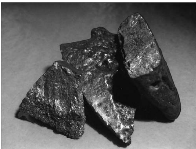
Abb. 53. Roheisen (Mitte) und Harteisen von der Hütte Edlach. Coll. BBM Enzenreith; Foto. M. HACKENBERG.
