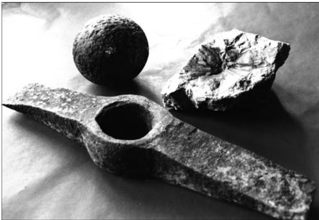
Abb. 68. Keilhaue, Cylpeps (Malmkugel,) Sternmagnetit vom Bergbau Eichberg. Coll. BBM Enzenreith; Foto N. VÖLKERER.
