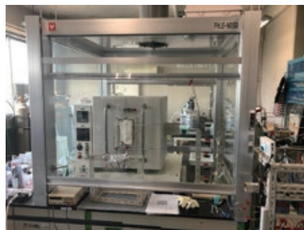
図 2 CO 2 電解試験装置 Fig. 2 CO 2 Electrolysis test apparatus
