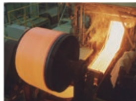
図 2 スクラップ鉄からのストリップキャストによる薄板創製
