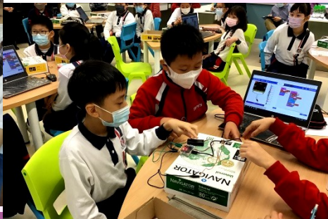
同學製作電子迷宮，並利用 micro:bit 編寫程式控制電子迷宮的聲響效果，同時能自動計算分數
