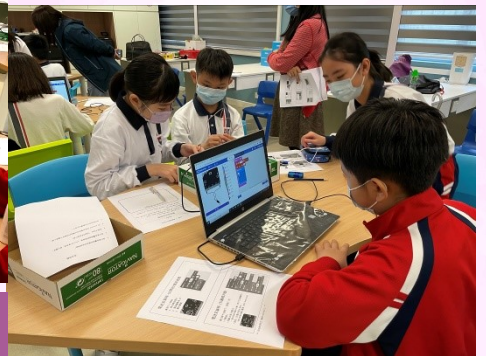
同學製作電子迷宮，並利用 micro:bit 編寫程式控制電子迷宮的聲響效果，同時能自動計算分數
