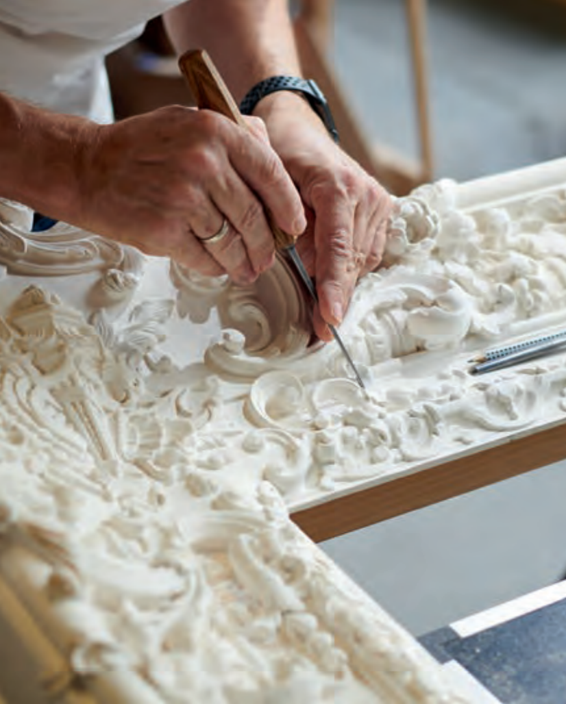
57 Der Holzbildhauer Stephan Thürmer schneidet den Kreidegrund des Bilderrahmens für den Eckparadesaal nach
