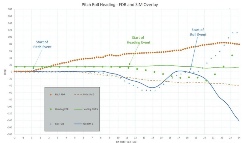
Figur 23. Avvikelse mellan värden registrerade i DFDR och simulerade korrekta värden.
