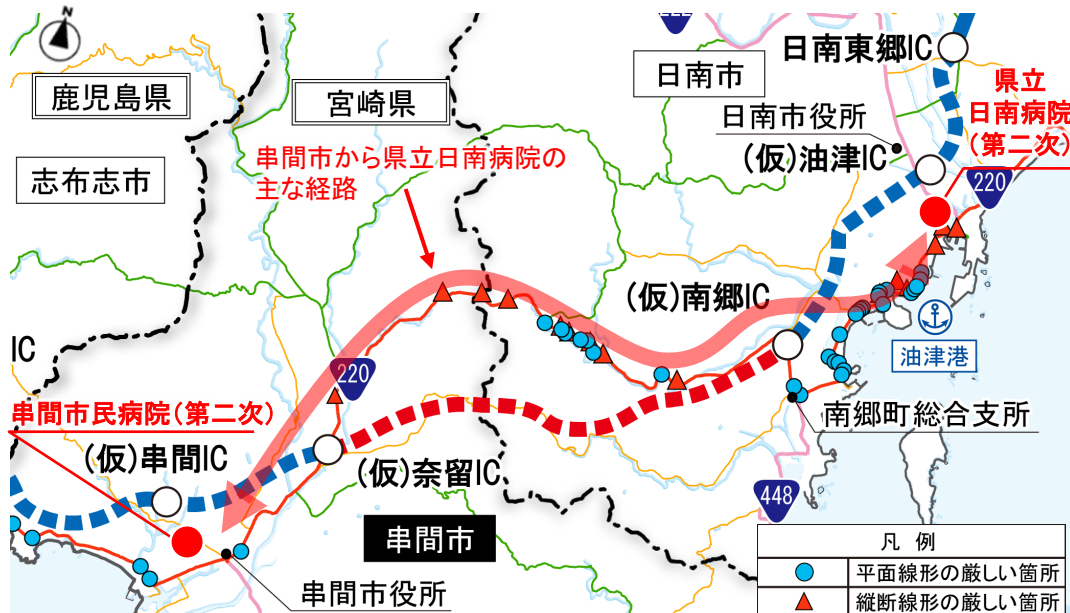
■ 国道220号の線形(平面・縦断)不良箇所
