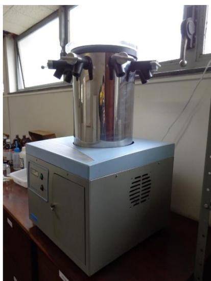
*Liofilizador para secagem de amostras*
