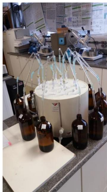
*Processo inicial de extração em fase sólida de amostras líquidas para determinação de contaminantes emergentes*
