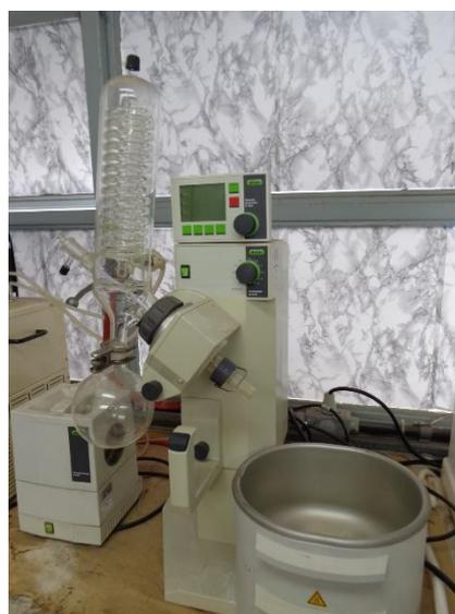
*Rotaevaporador – remoção de solvente*
