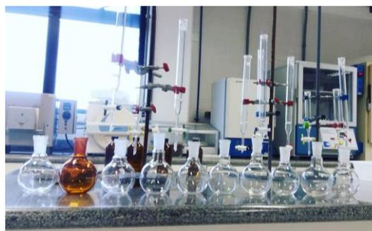
*Balões de fundo chato (a frente) e suportes para colunas de extração (ao fundo) utilizados nas etapas de determinação de contaminantes emergentes*
