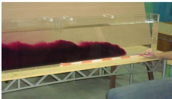
*Experimento de escoamento estratificado em canal de acrílico*
