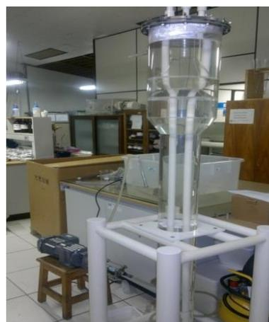
Reator tipo UASB em acrílico (50 L)
