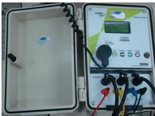
*Medidor de corrente elétrica*
