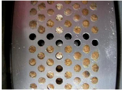
Fig. 1.29. Particolare interno della trafila per pellet
