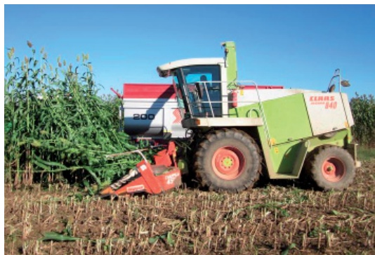
Fig. 1.24. Falcia-trincia-caricatrice in azione su sorgo
