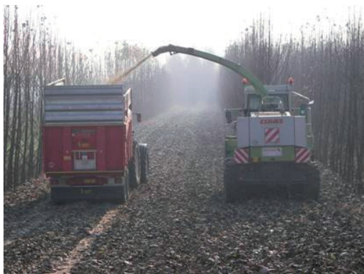
Fig. 1.13. Falcia-trincia-caricatrice in azione su filare di pioppo con l'ausilio di rimorchio laterale
