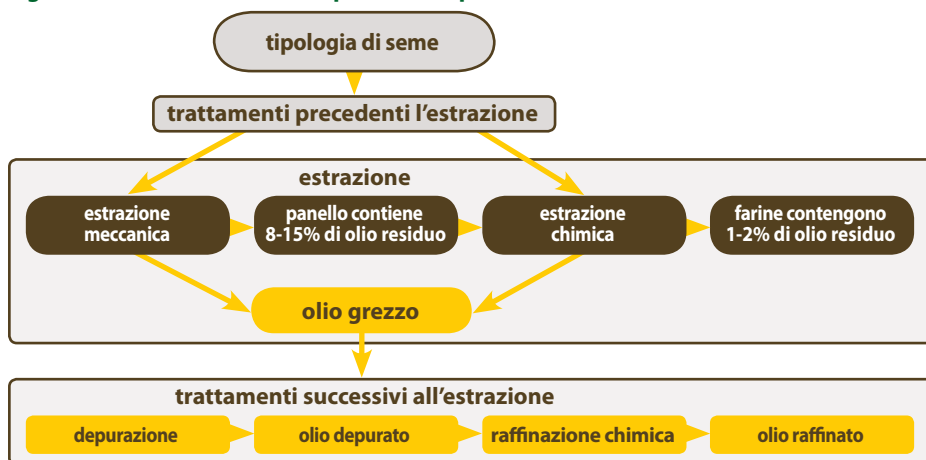
Fig. 1.31. Schema sintetico del processo di produzione dell'OVP
