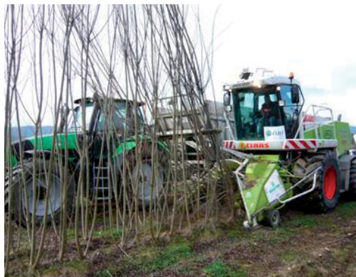
Fig. 1.16. Falcia-trincia-caricatrice su filare di pioppo
