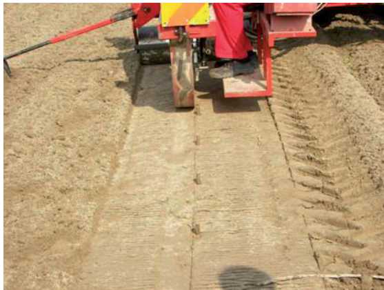
Fig. 1.15. Particolare di una trapiantatrice per talee di pioppo
