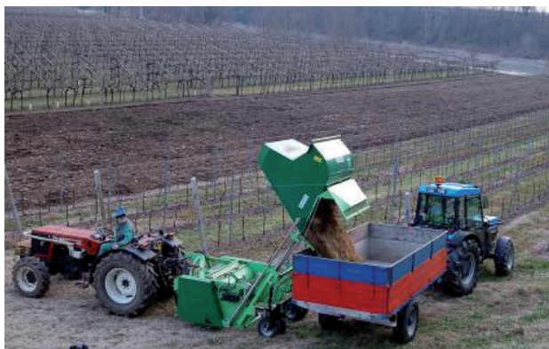
Fig. 1.1. Macchina trincia sarmenti con contenitore posteriore ribaltabile
