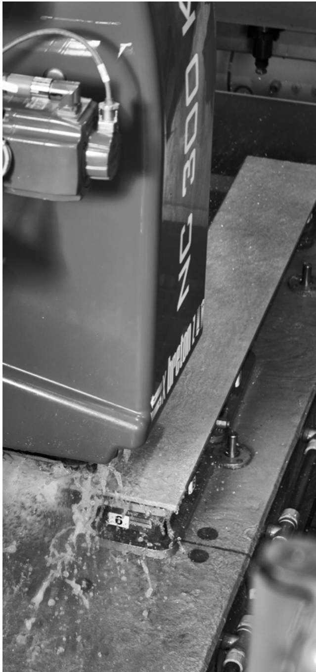
CNC EDGE PROFILING (FIG.37.1)
