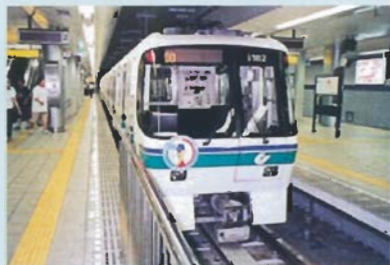
観客の線路上転落防止措置
