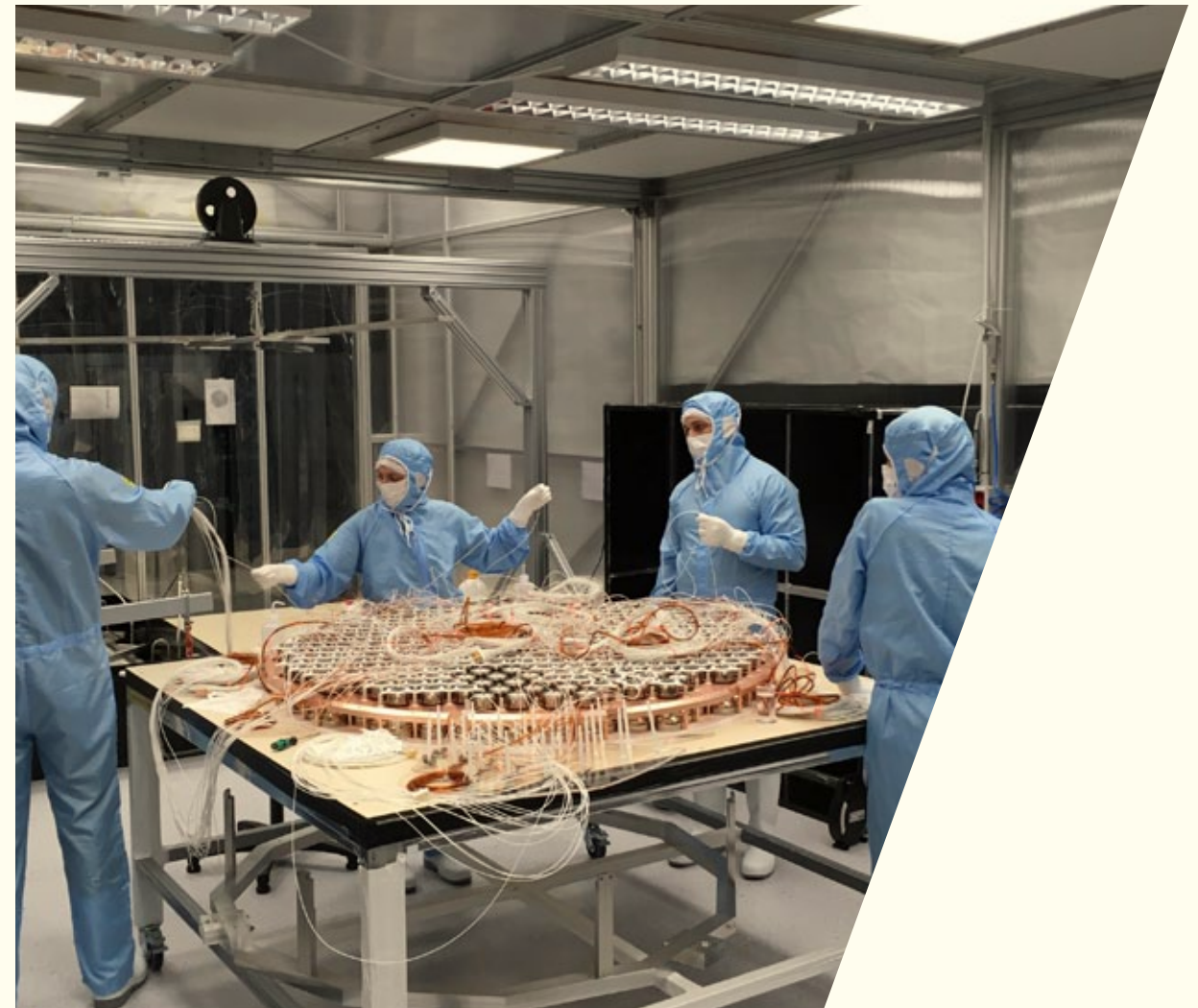
Preparing the PMT array at XENONnT, Gran Sasso.
