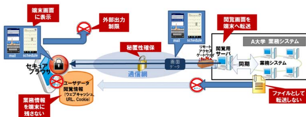
図9 セキュアブラウザ活用型ソリューションのシステム構成例
