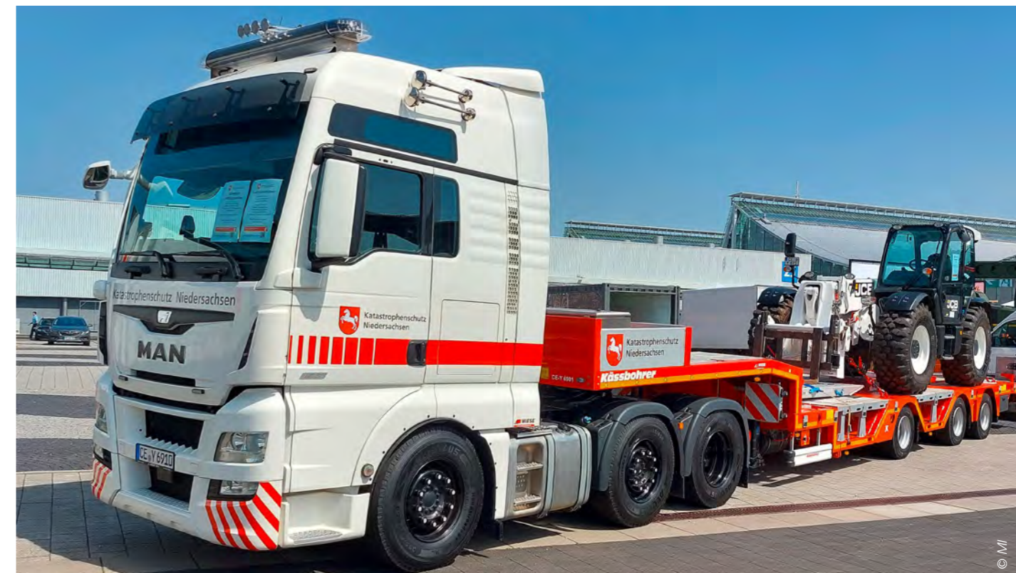
Sattelzugmaschine mit Sattelauflieger und verladenem Teleskopklader im Außenbereich der Messe
