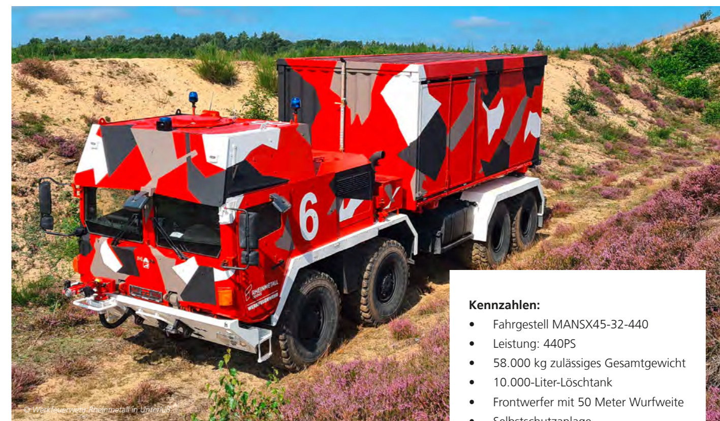
GTLF 1000 – Eigenbau/Prototyp der Werkfeuerwehr Rheinmetall in Unterlüß: Gepanzertes Tanklöschfahrzeug mit besonderem ballistischen Schutz
