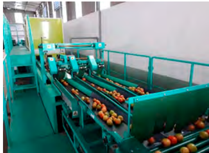
試験導入された日本式高度選果機 資料：JICA(独立行政法人国際協力機構)
