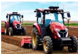
無人のロボットトラクタと 有人のトラクターの協調作業
