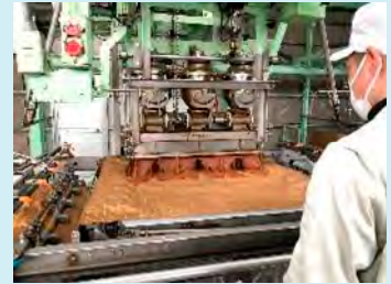
熟成したもろみを 圧搾する工程
