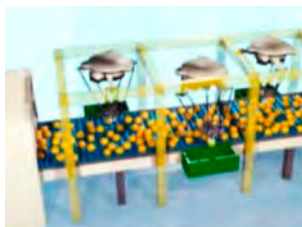
腐敗果を排除するロボットハンド
