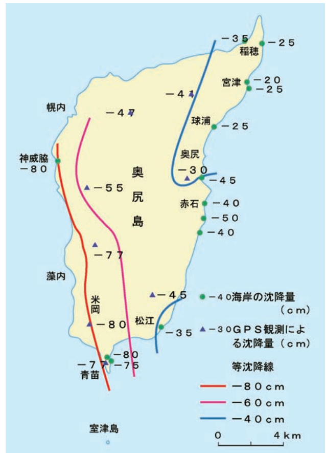
図3-19 「平成5年(1993年)北海道南西沖地震」による奥尻島の上下変動 [国土院地理調査部(1993)による] 奥尻島の西岸は80cm、東岸は20~50cm程度沈下した。
