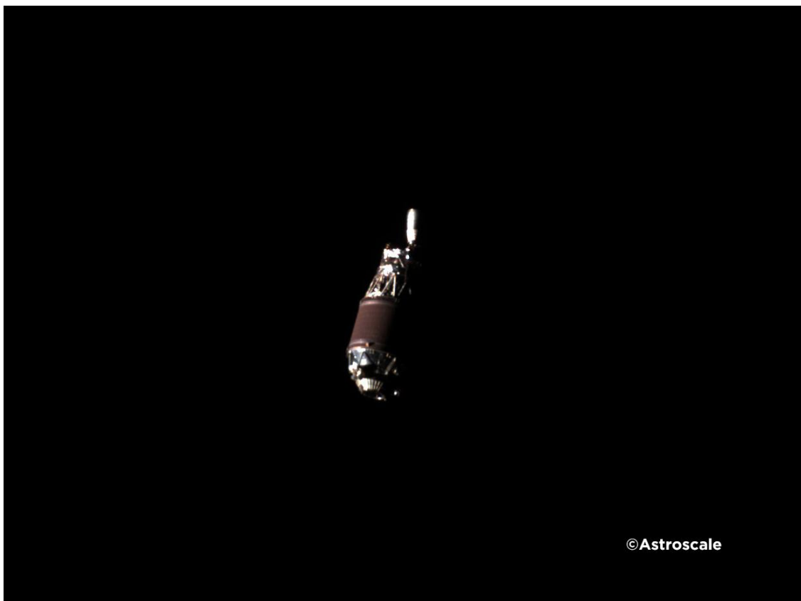
図: ADRAS-J 可視光カメラによるCRD2のターゲットスペースデブリの画像 (2009年に温室効果ガス観測技術衛星「いぶき」(GOSAT)を打上げたH-IIA ロケット上段, H-2A R/B, International designator: 2009-002J, Catalog Number: 33500)
