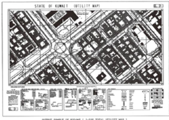
図 3 総合地下埋設物管理図 (原図はカラー 1:500)
