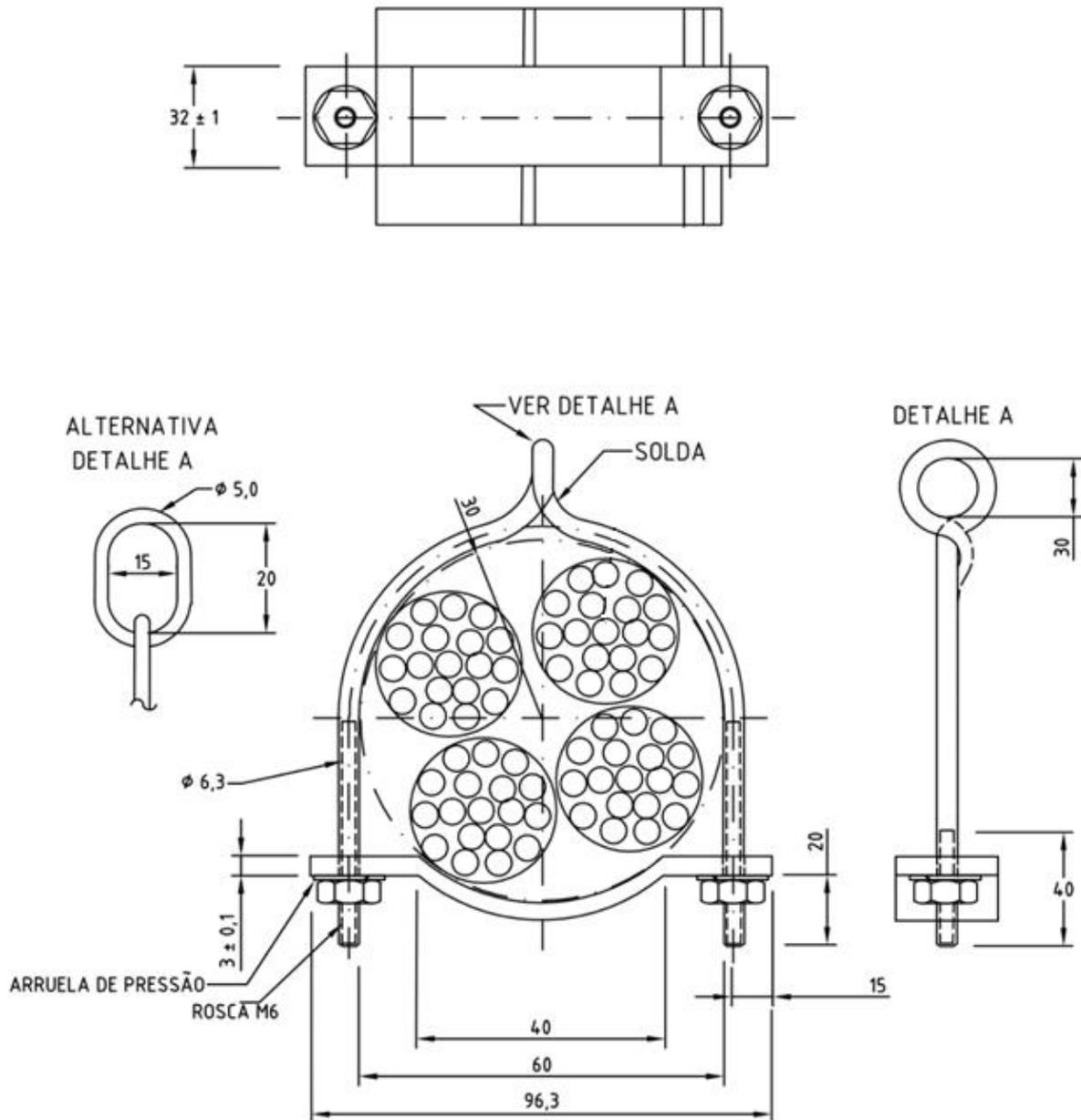
**Figura 1** - Abraçadeira para Fixação de Ramal de Ligação
