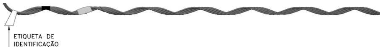
Figura 1: Protetor Pré-formado para Amortecedor de Vibração para Cabo ACCC
