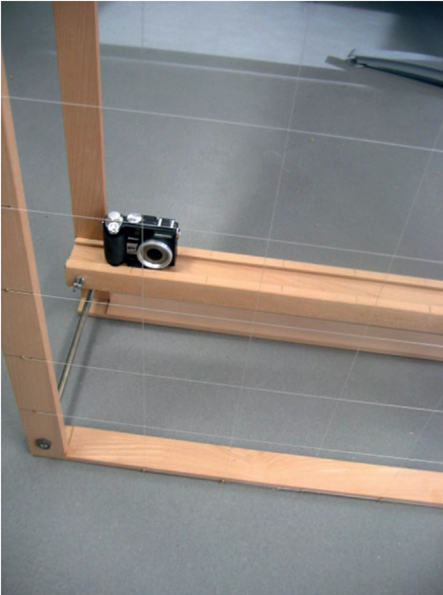
Abb. 37: Vorrichtung zur fotografischen Erfassung des Heiltumsschranks mit Rastereinteilung
