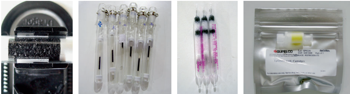
Abb. 16: Sammler für Erfassung von flüchtigen organischen Verbindungen; von links nach rechts: Aktivkohle-Passivsammler, Tenax-Aktivsammler, Silikagelsammler, DNPH-Sammler
