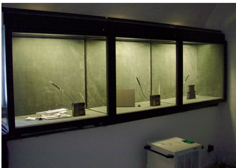
Abb. 14: Überprüfung des Emissionspotenzials verschiedener Materialien (linke und mittlere Vitrine) und eines Exponats (rechte Vitrine) in „neuen“ Testvitrinen in der Schatzkammer vor dem Umbau
