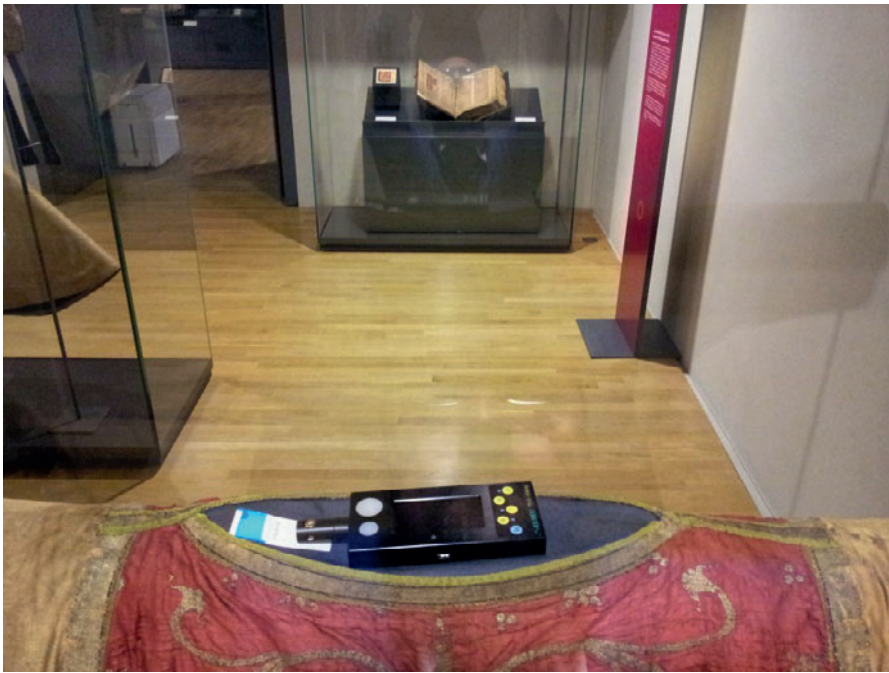
Abb. 31: Parallelmessung der Beleuchtungsstärke mit einem Lichtdosimeter vom Typ Light Check sensitive sowie einem Lichtmessgerät vom Typ ELSEC 775C
