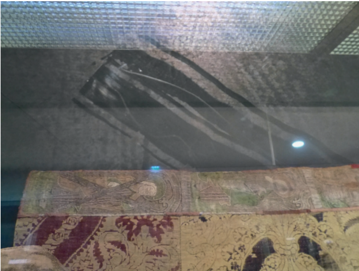
Abb. 23: Weißlicher Belag auf der Innenseite der Glasscheibe in Vitrine V4.10.6 „Schwarzes Samtpluviale“ (Inv.-Nr. 213)
