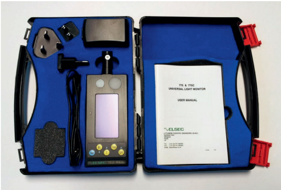
Abb. 28: Lichtmessgerät vom Typ ELSEC 775C für die Messung von Licht im sichtbaren Wellenlängenbereich, im UV- sowie im IR-Bereich
