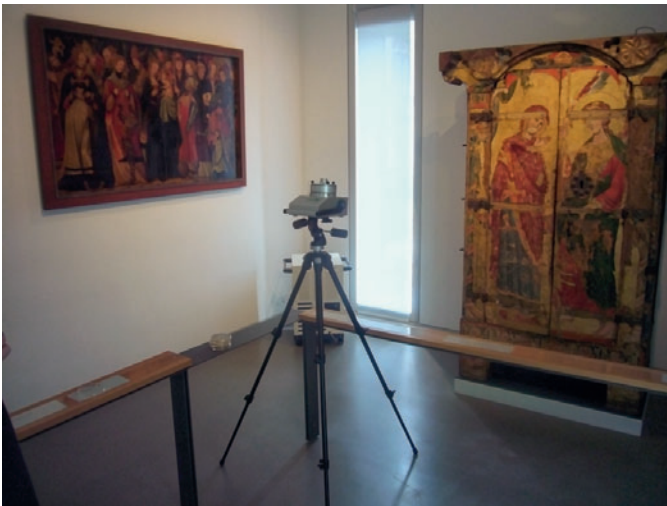
Abb. 9: Luftkeimmessung im Liebfrauenraum
