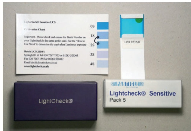
Abb. 30: Lichtdosimeter vom Typ Light Check sensitive
