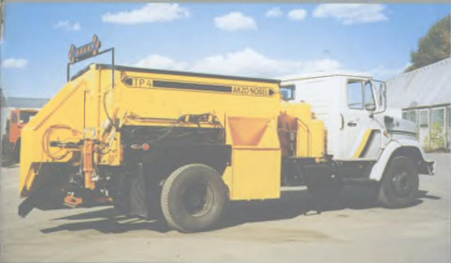
Машина для комплексного ямочного ремонта
