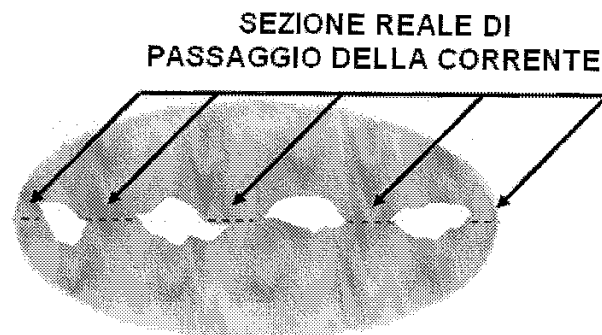
Figura 2.3.5 – Superficie effettiva che definisce la resistenza di contatto. [5]
