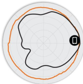
Abbildung 4. T310d 2,4 GHz-Elevation-Antennenmuster
