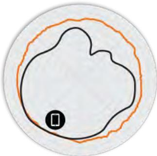
Abbildung 3. R510 5 GHz-Azimet-Antennenmuster
