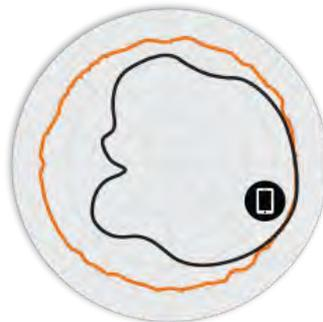
Abbildung 4. R510 2,4 GHz-Elevation-Antennenmuster
