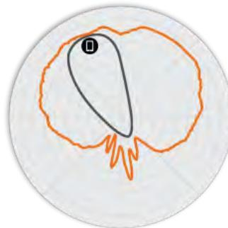
Abbildung 5. R510 5 GHz-Elevation-Antennenmuster
