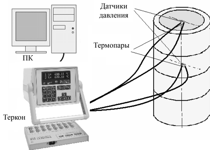
Рис. 4. Схема установки для измерения температуры и криогенного давления при одномерном промерзании во влажном дисперсном материале
