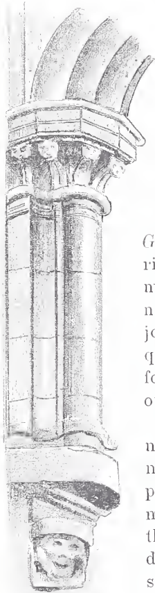
Console, pilier N.-E.
