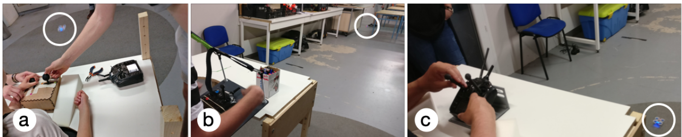
FIGURE 2: Participants pilotant les drones lors d'un atelier, les drones sont entour s par des cercles blancs. a) P1 avec la table adaptable et la boite en bois pour cacher et diriger la manette; b) P3 avec la manette pos e sur la tablette fix e aux  paules; c) P4 avec la manette pos e sur un support inclin  et des mousses pour soutenir les avant-bras.
