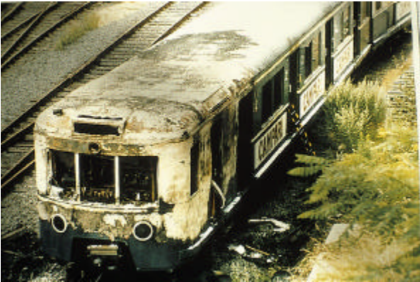
Bild 4a: Ganzstahlkarosserie; Brandunfall der Hamburger S-Bahn am 24. Juli 1979
