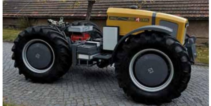
RigiTrac EWD 120 ohne Fahrerkabine: Generator mit Bremswiderstand (rot und silber); Leistungselektronik (grau)
