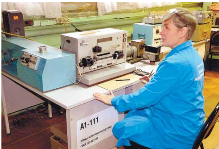
Прибор «Игла-0,23», предназначенный для испытания на механическую прочность
