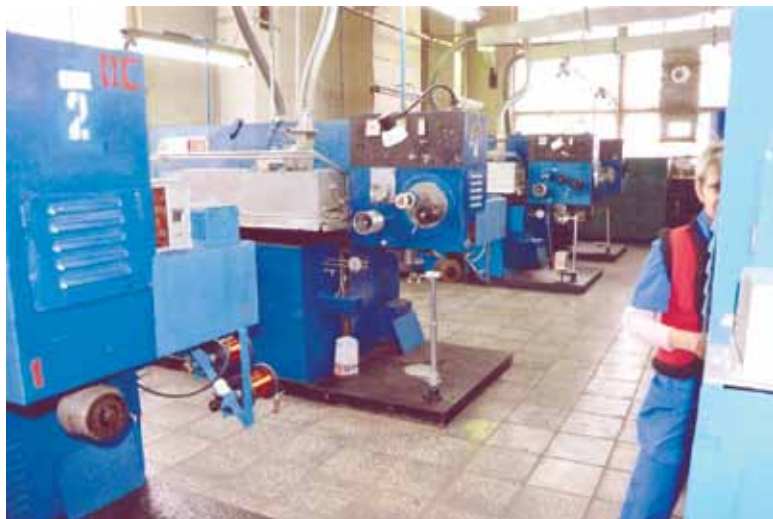
Этот эмальагрегат ПГЗ – продукция ОС (для космической отрасли) – также изготовлен в СПКБ
