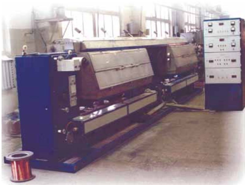
Современная установка СПКБ для нанесения гальванических покрытий
