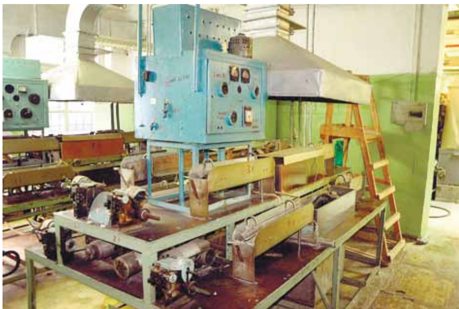
Эксплуатационные линии гальванического покрытия проводников металлами (оловом, никелем) тончайших размеров. Завод «Микропровод», 2013 г. Оборудование изготовлено в 1977 году
