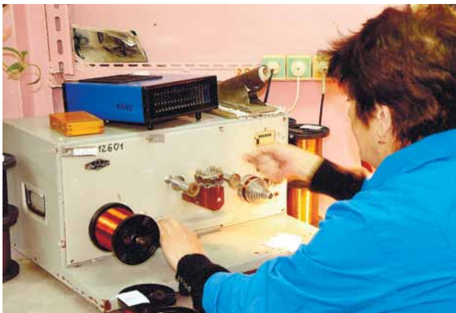
Проверка эмальпровода на точечные повреждения
