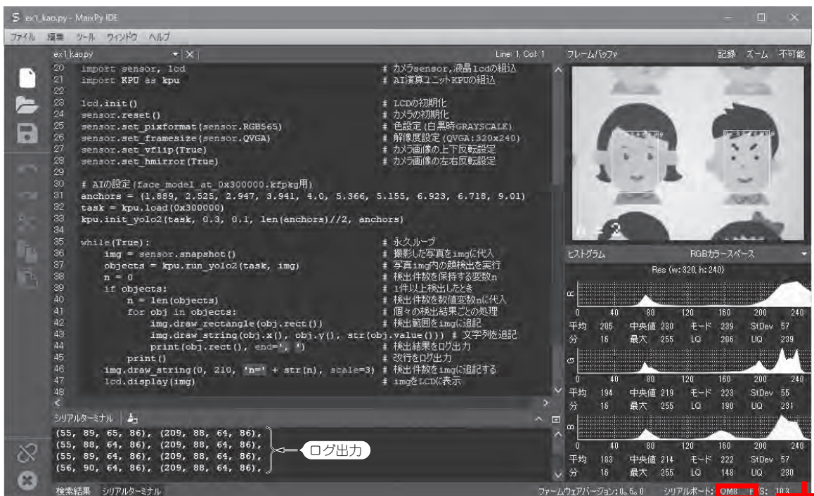
図2-1 AIカメラによる顔検出の基本機能ex1_kao.pyを実行したときのようす AIカメラが顔検出した画像位置と大きさをシリアル・ターミナル(画面・左下)にログ出力する
