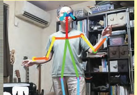
CNN(畳み込みニューラル・ネットワーク)の学習済みモデルで、人間の姿勢を検出するモデルを試す
