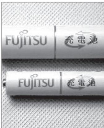
ニッケル水素(NiMH)蓄電池は1990年に実用化され、ノート・パソコン、ビデオ・カメラ、携帯電話などのモバイル機器や、工具、ハイブリッド自動車などの動力用途に使われてきました。最近では、IT機器や医療機器、インフラ機器、電力貯蔵にも使われています。
