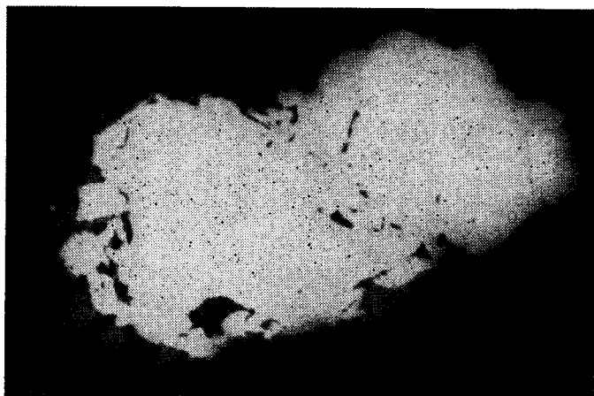
Рис. 1. Каймы вожминита (светло-серое) и магнетита (темно-серое) вокруг хизлевудита (белое) в серпентините (черное). Полированный шлиф. Увел. 125.
