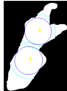
Figura 4. Exemplu caz critic în care metoda directă ar alege primul cerc. Aplicând măsura putem diferenția astfel de situații. Segmentele de cerc figurează cu cyan
