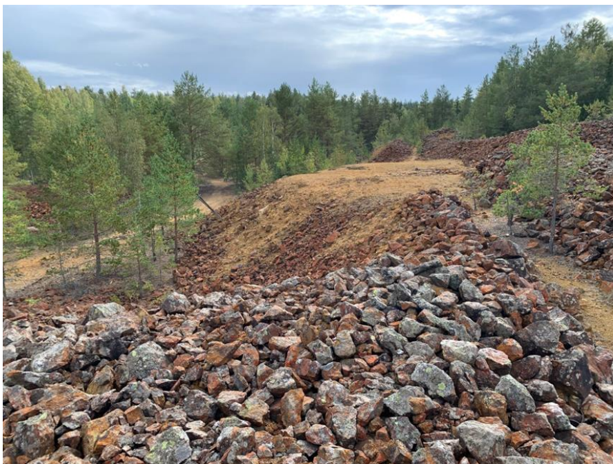
Figur 4. Karakteristiskt delvis rostvittrande varphögar (p.g.a. innehåll av sulfidmineral), här vid Tomtebo gruvor, Dalarna. Foto: Helge Reginiussen.
