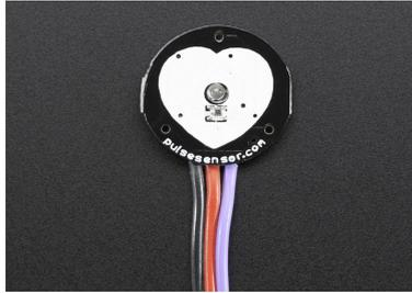
**Fig. 5.** Sensor de pulsos ADA-1093.
