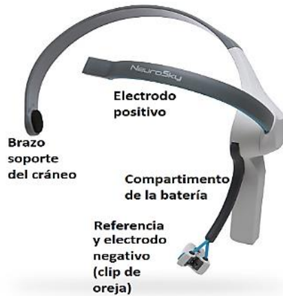
Fig. 2. Diadema MindWave MW001 NeuroSky®.
