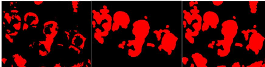
**Fig. 2.** Izquierda: Segmentación por umbralización, Centro: Rellenar huecos, Derecha: Remover objetos pequeños.
