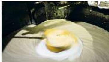
Les balles de papiers sont plongées dans un gros mixeur : **le pulpeur**. Ce brassage avec l'eau permet de séparer les fibres de cellulose.
