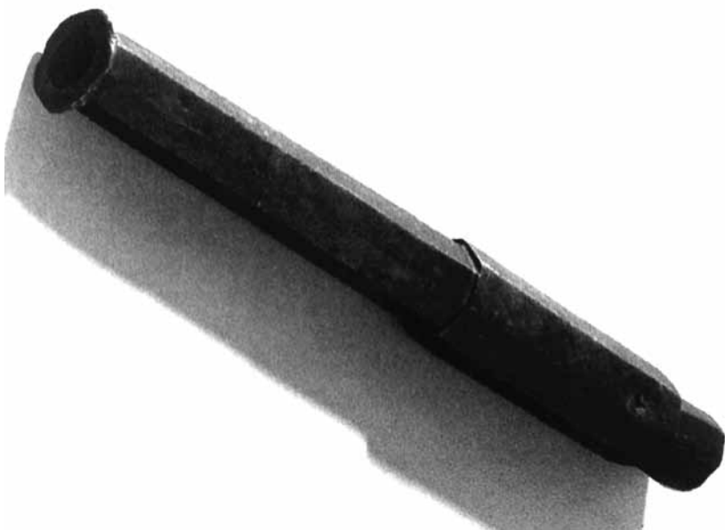
Ryc. 7. Ręczna broń palna z Tannenbergu w Hesji, która trafiła do ziemi w czasie oblężenia zamku w 1399 r. (Germanischen Nationalmuseum Nürnberg). Długość 32 cm (bez tulei 27 cm), kaliber części wylotowej 14,5-17,5 mm (według różnych danych), masa 1,24 kg. Patrząc od prawej można wyróżnić kolejno: tuleję służącą do osadzenia broni na drewnianym trzonie-łożu, pogrubioną część denną (komorę prochową z widocznym na zdjęciu otworem zapalowym), a także cieńszą część wylotową zakończoną pogrubionym względem niej wylotem. Źródło: P. Strzyż, op. cit., s. 218, tab. II.4.
