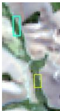
図 6.1 Hansen Loss 誤抽出の例（皆伐箇所に残された天然林が誤抽出されている例） （背景：Landsat 画像）
