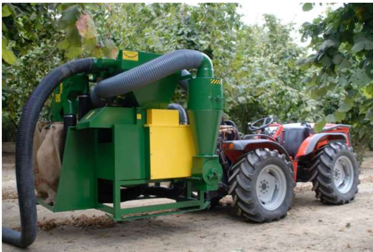
Figura 7 – Macchina aspiratrice portata
