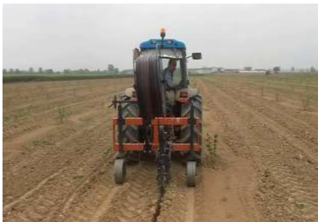
Fig. 15 – Stesura ala gocciolante subirrigazione
