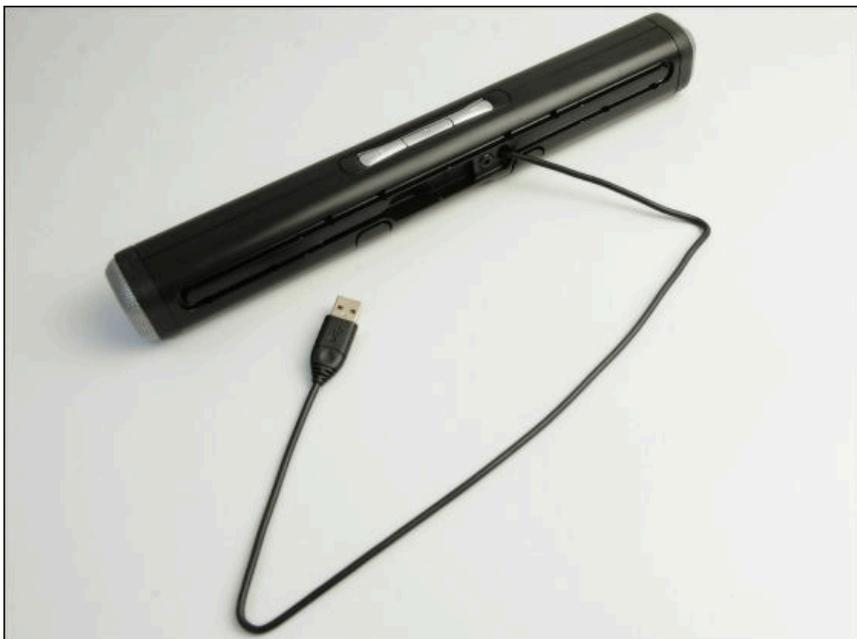
左右に備えたスピーカーの定格出力は約1.2ワット。「レッツノート CF-SX1」に搭載されたスピーカーの出力が約0.4ワットなので、こういった機種と比較すると4倍の出力があります。
