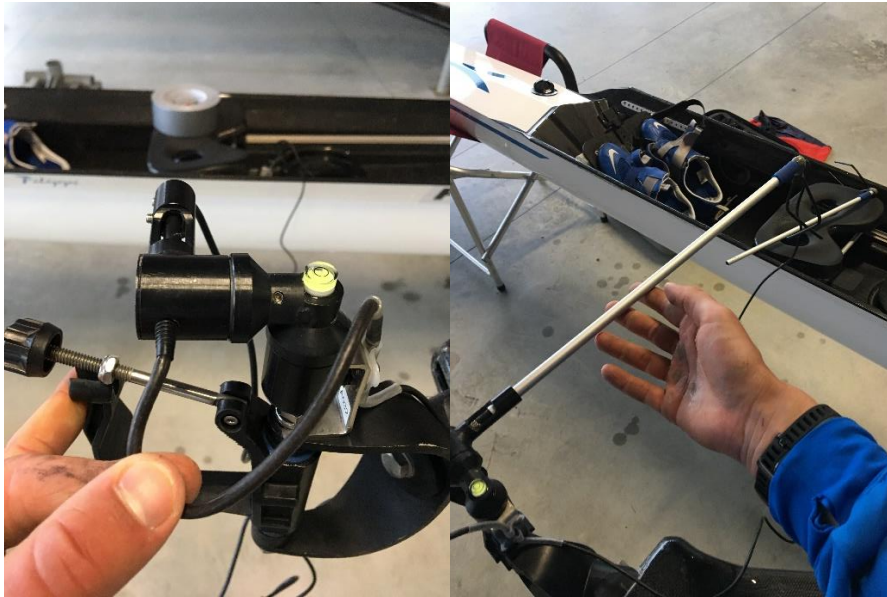
Kuva 10. Airon kulmasensorin kiinnitys
