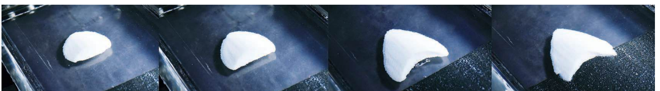
Na sequência, experimento que reproduz, em laboratório da Faculdade de Engenharia Mecânica, o processo de formação de dunas
