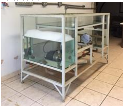
Figura 4 – Mesa d'Água do Laboratório de Conforto Ambiental do IAU-USP, utilizada para análises qualitativas de ventilação natural, Fonte: Os autores
