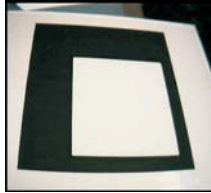
Figura 2.4: Distorção radial: linhas retas aparecem curvas na imagem.
