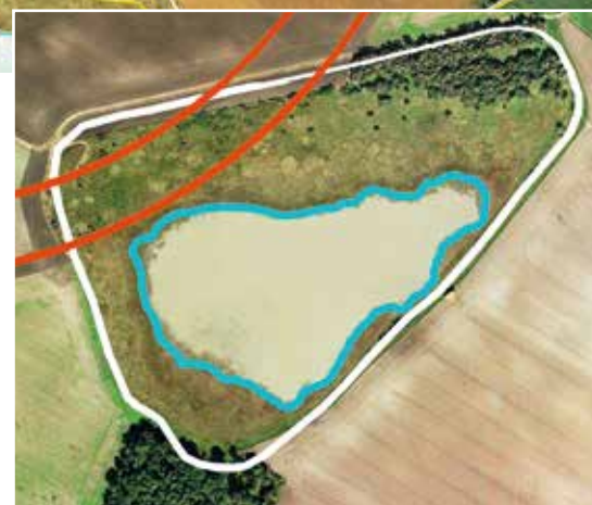
90/1: Oben – der hellblaue Rand markiert die Grenze zwischen Wasserfläche und Vegetation im Jahr 2000. Unten – 2010 ist die Vegetation bereits über den hellblau Rand in die freie Wasserfläche vorgedrungen.
