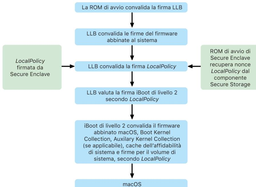
Nel primo passaggio della catena di attendibilità, il chip esegue del codice dalla ROM di avvio. L'avvio protetto di macOS sui Mac dotati di chip Apple verifica non solo il codice del sistema operativo stesso, ma anche le politiche di sicurezza e persino le estensioni del kernel (supportate, ma non consigliate) configurate dagli utenti autorizzati.
